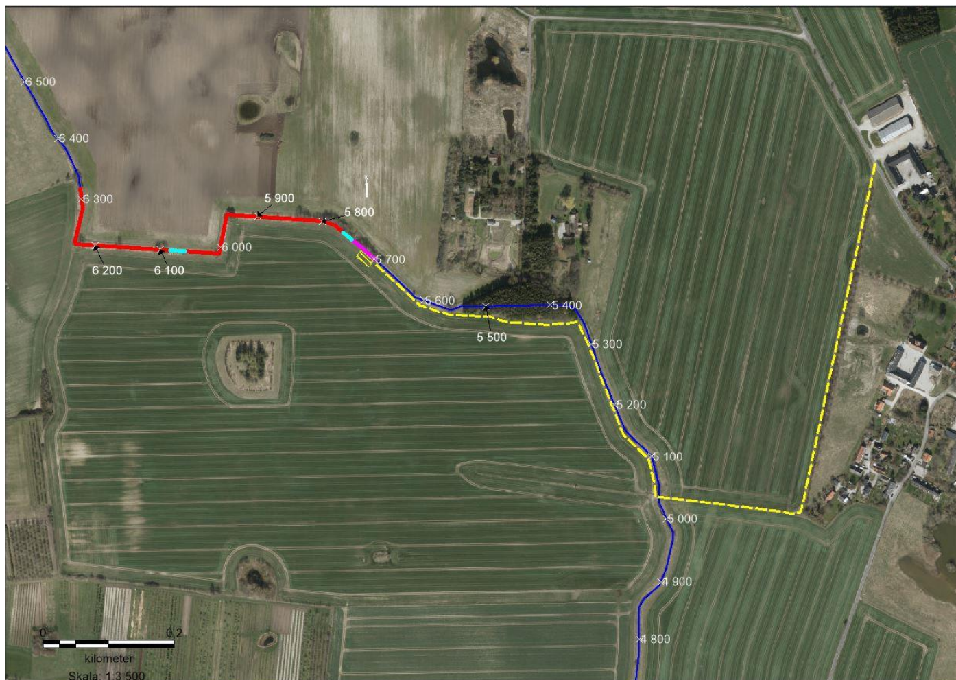
Figur 3.7 Restaureringstiltag for strækningen st. 5700 - 6300 m. hvor der udføres udskiftning af bundmateriale og udplantning af træer (rød streg), indsnævring af vandløbsprofil (lilla streg) og etablering af gydebanker (turkis streg), samt adgangsvej (gul stiplede linje) og arbejdsplads (gul skraveret).
