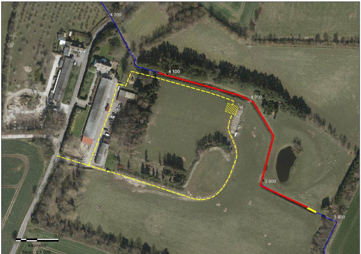
Figur 3.3 Restaureringstiltag for strækningen St. 3823 - 4115 m, hvor der etableres sandfang (gul streg), udskiftning af bund og udplantning af Rødel (rød streg), samt adgangsvej (gul stiplede linje) og arbejdsplads (gul skraveret).
